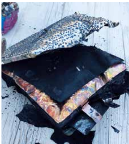
ausgebrannter Lithium Akku
