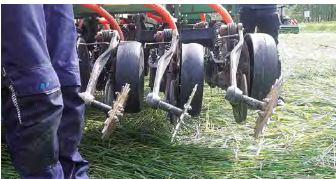
Mit der Maschine kann die Zwischenfrucht in einem Arbeitsgang eingewalzt und der Mais direkt darauf gesät werden
