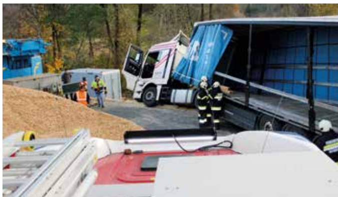
Missliche Lage: Sattelzug übersieht Rampe; aufwendige und schonende Bergung mit 2 Seilwinden und Bergekrane.
